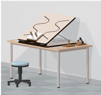
※ W900 (GI-0909) に 握り棒タイプ両手用ハンドル (GI-RYO) を 設置した例
